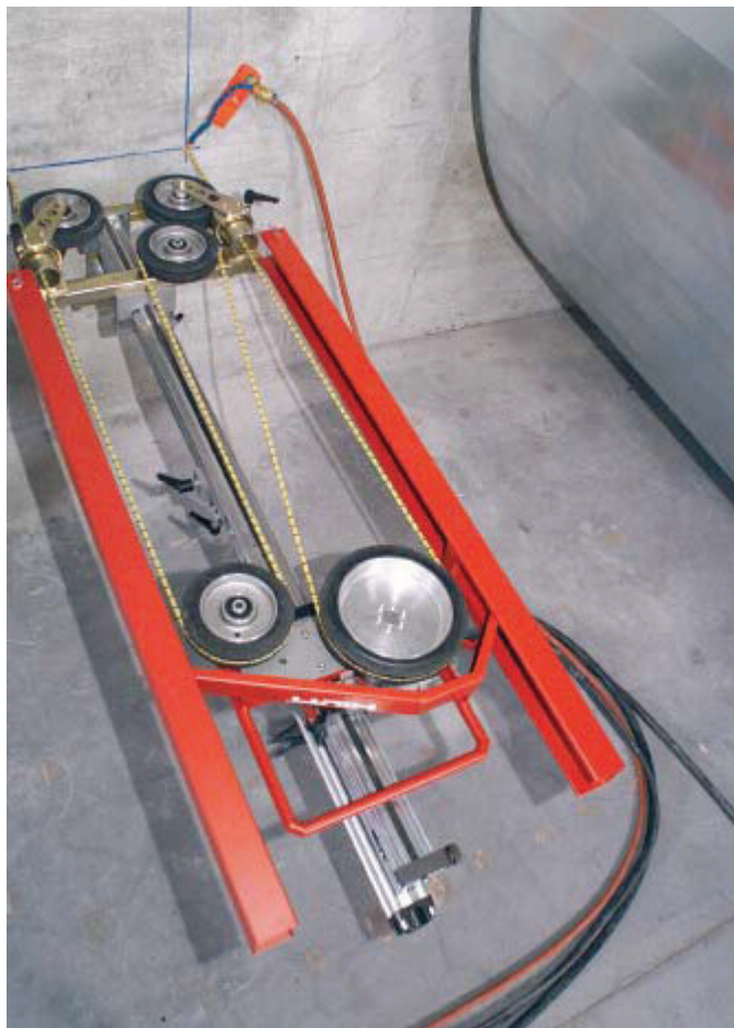
Anslut tryckluftsslangarna till cylindern
