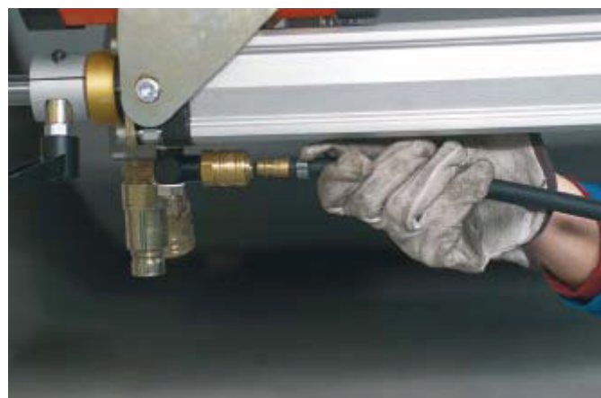
Anslut tryckluftsslangarna till cylindern
