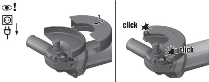
1. フロントカバーの閉じた側を標準保護カバーにロックするまで取り付けてください。
